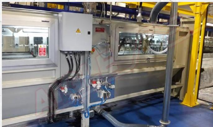
L'ensemble de l'installation est donc conçu pour permettre cette flexibilité. Un système de convoyeur à chaîne pas à pas permet un développement optimal du processus de production. L'unité d'application de colle est équipée de tampons de colle. L'installation de flocage, quant à elle, est équipée de pistolets électropneumatiques pour une distribution correcte du flocage.
