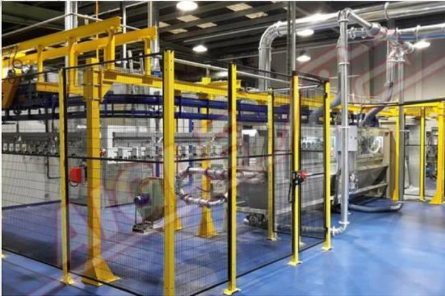
Im Laufe der Jahre hat **AIGLE** mehrere Beflockungsanlagen für Glockenisolatoren aus Gusseisen entwickelt. Der Isolator wird an der Öffnung beflockt, um Reibung mit anderen Materialien zu vermeiden, mit denen er während des Gebrauchs in Kontakt kommen soll.
