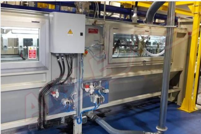
Die gesamte Anlage ist dann so eingerichtet, dass sie diese Flexibilität ermöglicht. Ein schrittweises Kettenfördersystem ermöglicht einen optimalen Ablauf des Produktionsprozesses. Die Leimauftragseinheit ist mit speziellen Pads ausgestattet. Die Beflockungsanlage ist mit elektropneumatischen Pistolen für die richtige Verteilung des Flocks ausgestattet.
