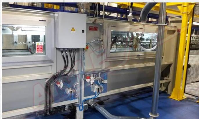
Вся установка настроена таким образом, чтобы обеспечить такую гибкость. Система пошаговых цепных конвейеров позволяет оптимально организовать производственный процесс. Установка для нанесения клея оснащена специальными подкладками. Установка для флокирования оснащена электропневматическими пистолетами для правильного распределения флота.
