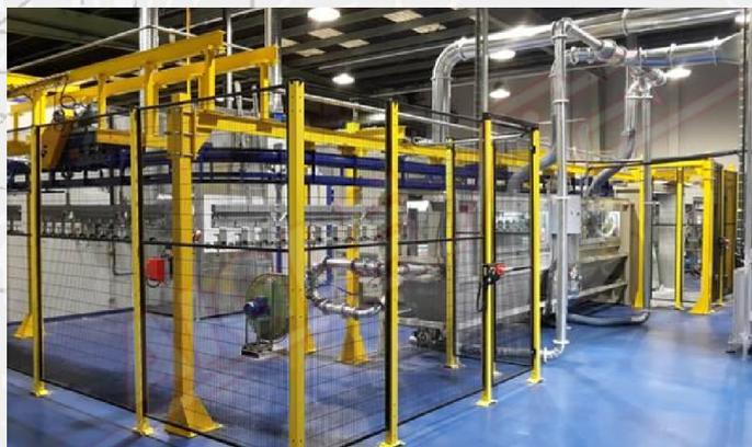
За годы работы компания **AIGLE** разработала несколько установок для флокирования чугунных колокольных изоляторов. Изолятор флокируется в отверстия, чтобы избежать трения с другими материалами, с которыми предполагается контактировать в процессе эксплуатации.
