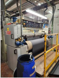
Der **Direktbeschichtungsprozess** dieser Anlage kann **mit einem oder zwei Beschichtungsköpfen** durchgeführt werden.
