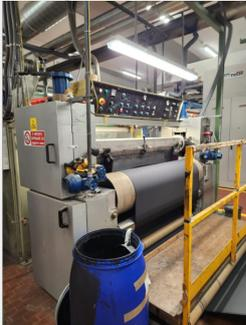
El **proceso de recubrimiento directo** de esta línea puede realizarse **con uno o dos cabezales de tejido recubierto**.
