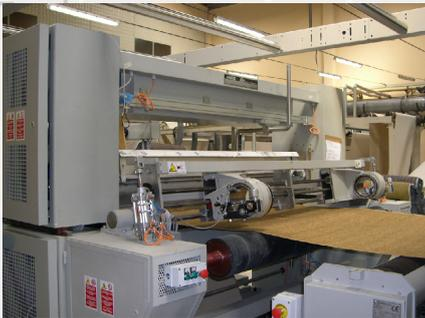
Die **Beschichtung Kopf mod. BS2** wurde so konzipiert und gebaut, dass verschiedene Beschichtungstechniken angewendet werden können.
