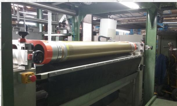
Сайт **Роторный грохот для нанесения покрытия мод. BS1** используется для нанесения покрытий и печати на ткани (с помощью пигментов, смол и клеев), а также для нанесения рисунка на флок.
