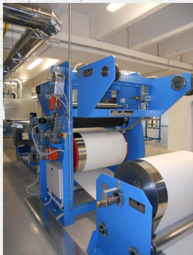
Сайт **ДУБЛИРОВАНИЯ мод. GRA/1** предназначена для технологии мокрого ламинирования и сухого ламинирования. В его состав входят:
