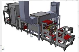
Le linee di coagulazione sono utilizzate per la produzione di filtri e di pelle sintetica. Si tratta di un processo ad umido. Il supporto viene prima impregnato o spalmato a racla o con slot e poi messo a contatto con acqua diluita con altri composti chimici.
