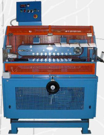
Les **Caterpillar mod. CTP800** se compose d'un cadre motorisé solide installé dans la partie inférieure et de deux courroies opposées de 10 mm recouvertes de caoutchouc "Poly V", installées dans la partie supérieure.
