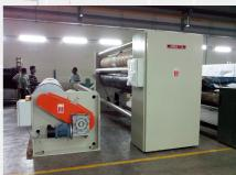
Les **Unité de calandrage mod. GG/IR** peut fonctionner avec des cylindres de calandrage à chaud ou à froid.
