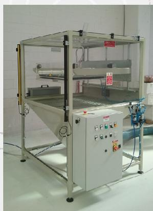
Les **Flocage Cabinet mod. CTA/TO** est conçu pour floquer des objets.
