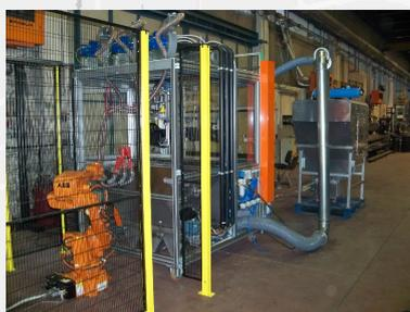
Les **armoires de flocage automatique mod. CA/R-ESP** se compose de
