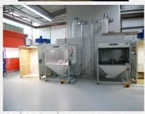
Les **Pulvérisation de colle Cabinet mod. CV** est fermée sur trois côtés et ouverte sur le devant.
