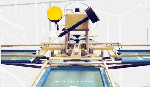
El **Generador electrostático mod. GE-100-1** pueden conectarse mediante un interruptor adecuado hasta un máximo de tres **APLICADORES EASY FLOCK**, que son activados sucesivamente por el operario. El grupo así compuesto es especialmente adecuado para trabajar en serigrafía de carrusel (imágenes de abajo), de modo que se pueden realizar flockados con más colores para diseños de camisetas, láminas, paneles, etc.
