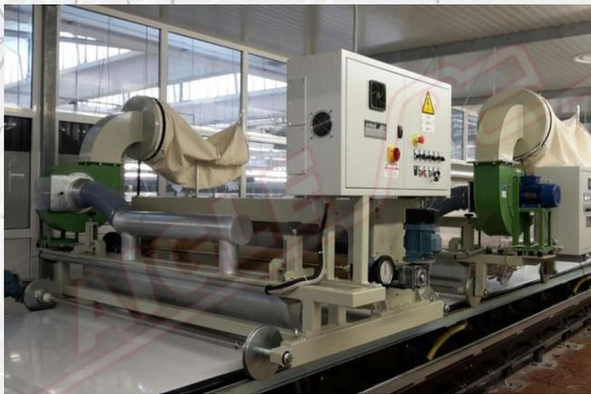
L'Unità di Distribuzione Glitter mod. TDP consiste in una tramoggia contenente il glitter, alla base della quale è montato un cilindro dosatore motorizzato a velocità regolabile comandato da inverter. Una racla posta sul cilindro serve a regolare l'uscita del glitter, mentre una spazzola rotante a velocità variabile controllata da inverter e opposta al cilindro, rimuove il glitter e lo distribuisce sul tessuto sottostante. È possibile accedere alla macchina grazie a pannelli di plexiglas.
