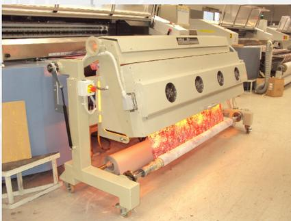
Innovativo gruppo di essiccazione per tessuti stampati con tecnologia digitale. L'unità può essere installata in uscita di un plotter tessile digitale. Principali caratteristiche dell'unità:
