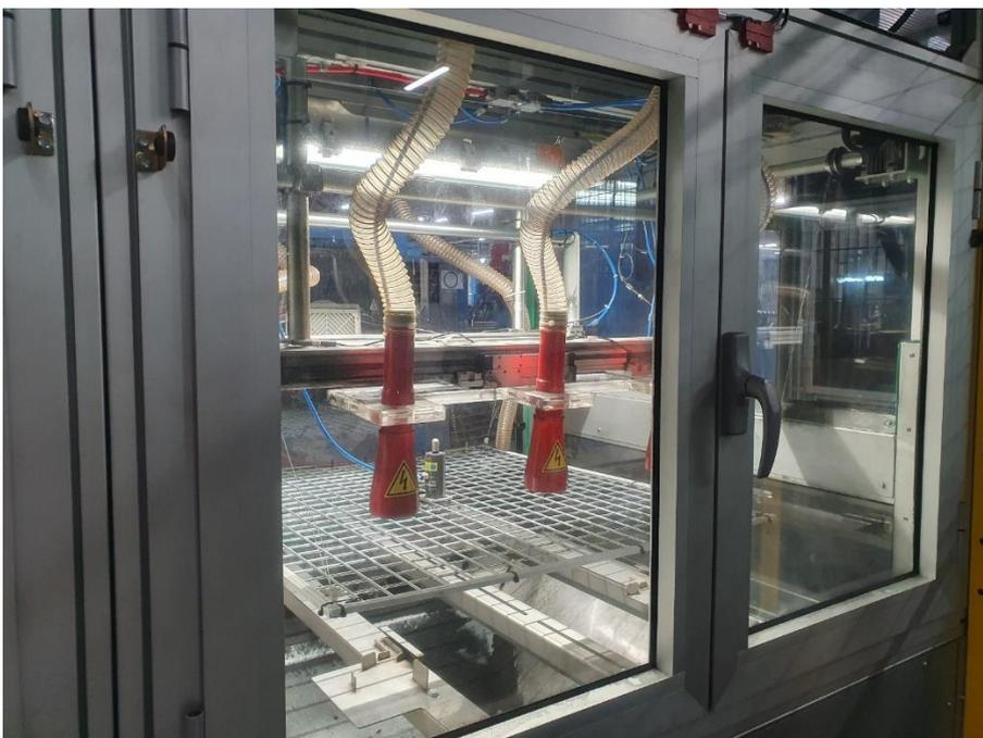
En el caso de los perfiles, las dificultades de flocado se multiplican por el hecho de que es complejo alcanzar las fibras de manera uniforme en toda la **sección del perfil**. Por este motivo, se decidió utilizar la técnica del flocado electroneumático, que, mediante una mezcla precisa de aire y flock, permite que las fibras lleguen a zonas difíciles de flocar.
