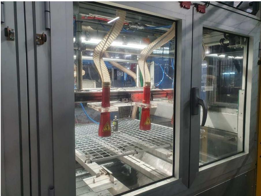
Per i profili le difficoltà di floccabilità si moltiplicano a causa del fatto che è complesso raggiungere con le fibre in modo uniforme tutta la **sezione** dei profili stessi. Per questo si è inteso utilizzare la tecnica del floccaggio elettropneumatico che, mischiando in modo preciso aria e flock, consente alle fibre di raggiungere aree di difficile floccabilità.
