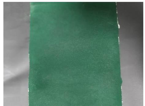
При нанесении мы получили сухой вес от 40 до 60 гр/кв.м. На трансферную бумагу и пвх мы нанесли прямое покрытие; на пенополиуретан мы нанесли клейкую пленку по технологии трансфера, сначала мы нанесли клейкую пленку на разделительную бумагу, затем перенесли ее на пенополиуретан.
